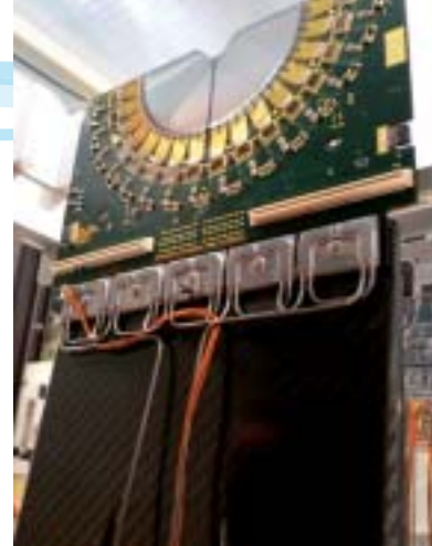
Koeling geïntegreerd in de LHCb detector.
